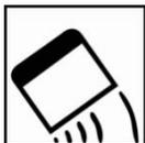
Appliquer le mastic polyester sur le métal nu en plaçant la cale à un angle de 60°. Éviter l'accumulation de produit sur les bords.
