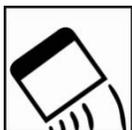
Appliquer le mastic polyester sur le support en plastique brut, en plaçant la spatule à un angle de 60°. Éviter les rebords de mastic trop épais sur le périmètre de la réparation.
