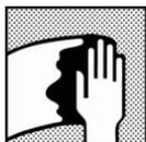
Avant le ponçage, nettoyer la surface avec un nettoyant de surface approprié.
